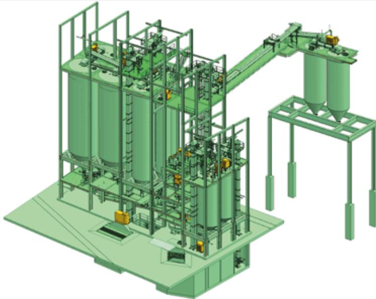
Dans une verrerie les matières premières requises sont stockées dans des silos, et dosé à partir de là dans des conteneurs en fonction des mélange nécessaire à la composition du verre. Les matières première sont mélanger et transporté par des bandes transporteuses ou dans des récipients vers le four à fusion de verre.
