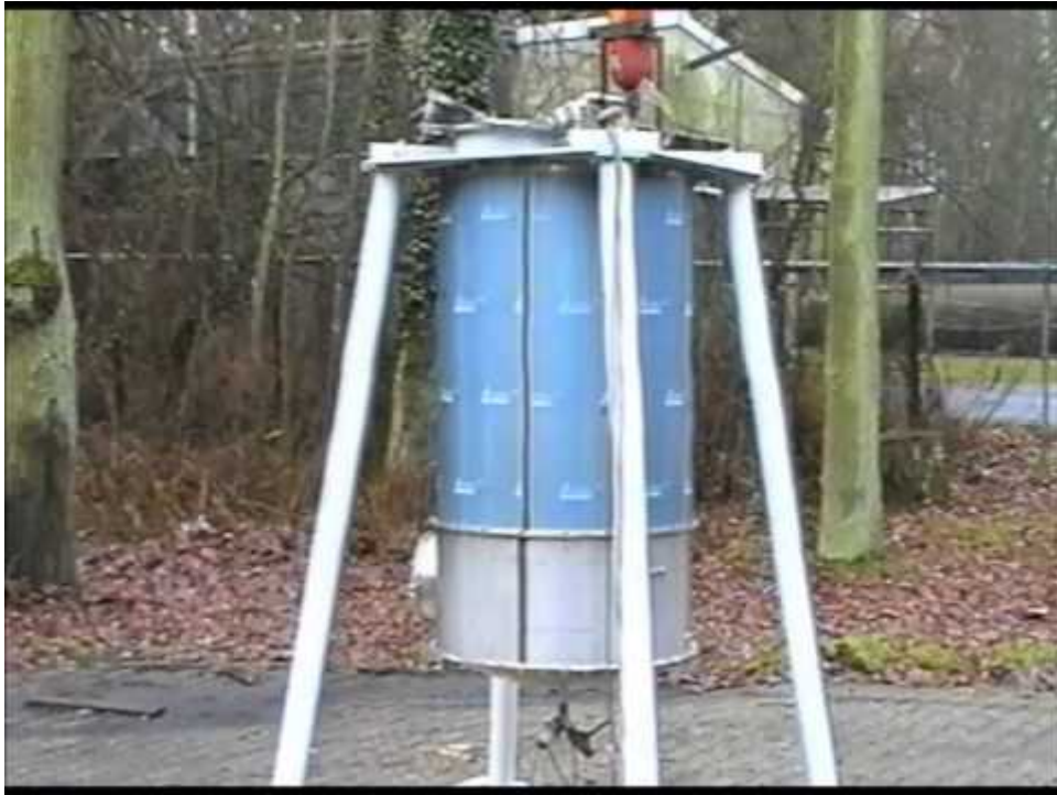
Explosionsversuche an einem Patronenfilter INFA-VARIO-JET Typ AJV zum Nachweis der Druckstoßfestigkeit.
